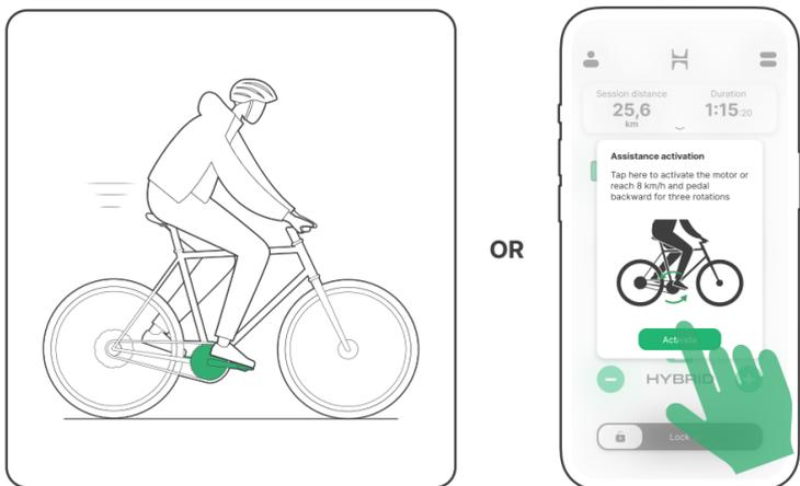
**5** Pedala in avanti per ricevere assistenza e pedala indietro per frenare e rigenerare energia.
